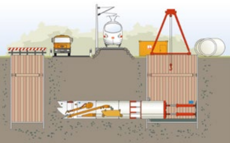
Systemskizze Rohrvortrieb mit Trockenförderung
