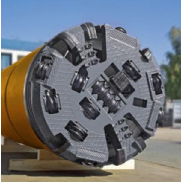
Vollschnittmaschine DN 1800, Fels-Bohrkopf
