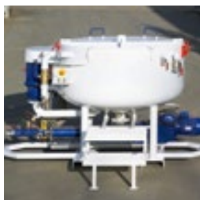
Bentonitmischer (oben), Bentonitventilanordnung bei Großröhren (rechts)
