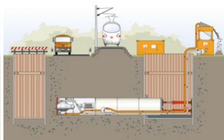
Systemskizze Rohrvortrieb mit Spülförderung
