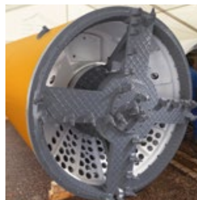
Vollschnittmaschine DN 1600, Lockerboden-Bohrkopf
