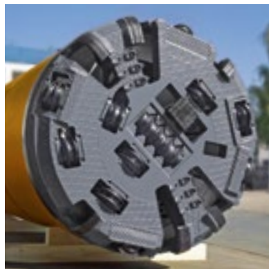
Vollschnittmaschine DN 1800, Fels-Bohrkopf
