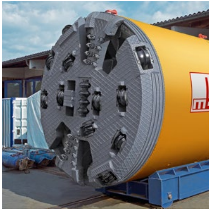
Vollschnittmaschine DN 2200, Fels-Bohrkopf
