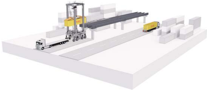
Carrierumschlag LKW – TSB aufgeständert
