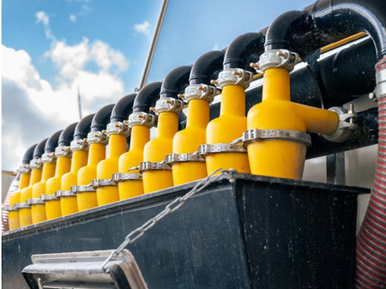
Durch moderne Recyclingtechnik wird die Bohrsuspension aufbereitet und im laufenden Bohrprozess wiederverwendet.
