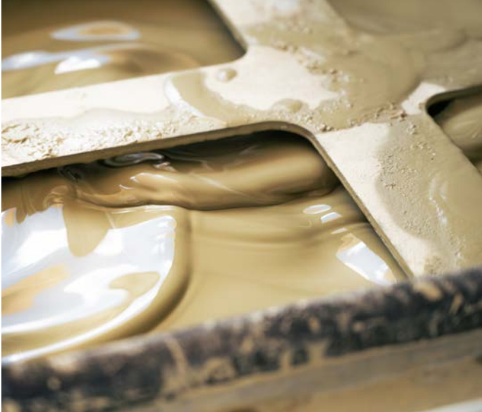
Effiziente Suspensionstechnologie zur Stützung des Bohrkanals
