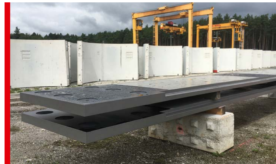
Projektunabhängige Bereitstellung von Bauteilen für die Hybride Bahnbrücke Bögl
